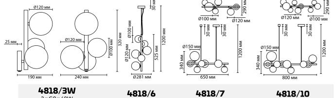
**4818/3W** 3 × G9 × 40W крепеж: планка выкл. на базе
