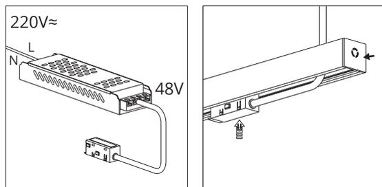
4. Установите подключенный ввод питания к шинопроводу. Вставьте адаптер до щелчка. Подключение осуществляется при выключенной электрической сети.
