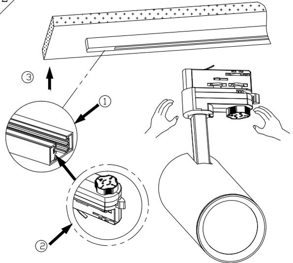
Положение зажима должно быть, как показано на рисунке после фиксации на шинпроводе.
