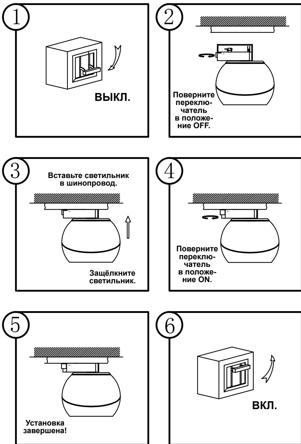
**ВНИМАНИЕ.** Все работы по монтажу шинопровода и установке светильников, замене ламп и техническому обслуживанию следует проводить при отключенном напряжении питания шинопровода.
