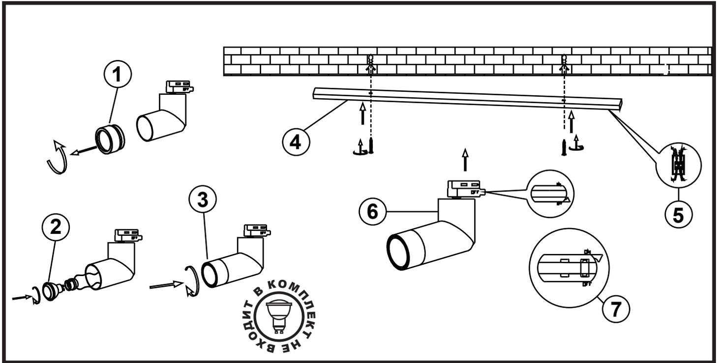
**ВНИМАНИЕ.** Все работы по монтажу шинопровода и установке светильников, замене ламп и техническому обслуживанию следует проводить при отключенном напряжении питания шинопровода. Категорически запрещается производить перемещение светильников вдоль шинопровода во включенном состоянии.
