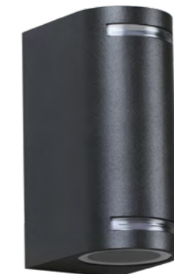
370839 IP 54 Светильник ландшафтный Корпус – алюминий/ рассеиватель – закаленное стекло GU10 max 2*15 Вт LED 220 В Диапазон раб. тем-р от -20° до +50° С
