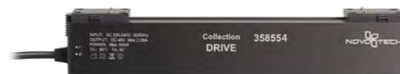
IP 20 Драйвер Корпус алюминий Выходная мощность 100 Вт Выходное напряжение 48 В Входное напряжение 200–240 В (Д*Ш*В) 281*38*50 мм
